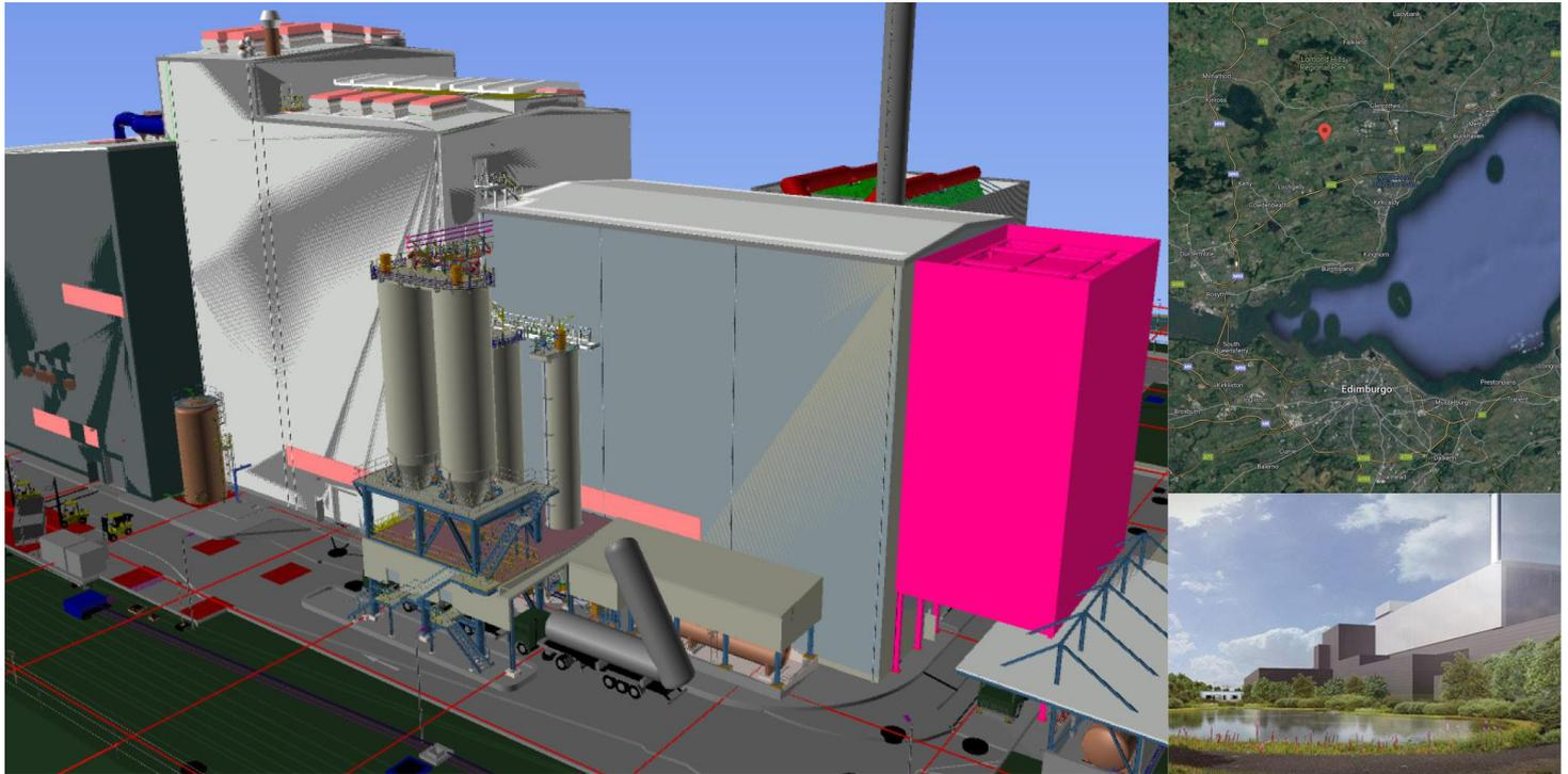
Proyecto de ingeniería estructural de las estructuras metálicas de una nueva planta de producción de energía a partir de la incineración de residuos para la empresa Westfield Energy Recovery Limited.
